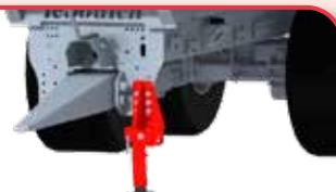
**SopORTE hidráulico retráctil** fijado directamente al bastidor de la bañera para liberar la lanza y facilitar la dirección.
