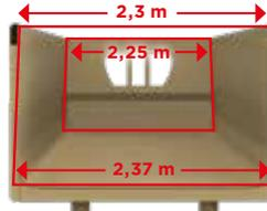
**Caja cónica** (2,25 m en la parte delantera y 2,3 m en la trasera), más ancha en la parte inferior que en la superior para facilitar la descarga.
