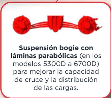
**Suspensión bogie con láminas parabólicas** (en los modelos 5300D a 6700D) para mejorar la capacidad de cruce y la distribución de las cargas.
